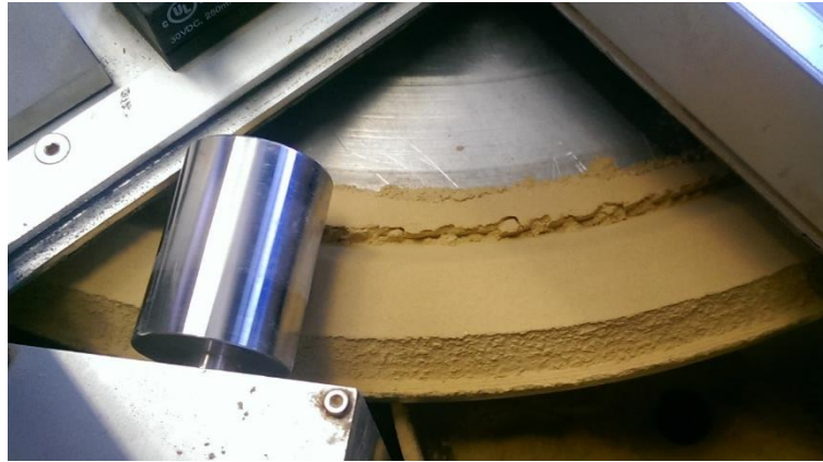
Abbildung 51: Fotografie der Spur des gemahlene Bodens A1 auf dem beweglichen Probenteller. Die Walze ebnet die Oberfläche der Spur. Der Röntgenmesskopf ist dabei links von der Walze positioniert.
