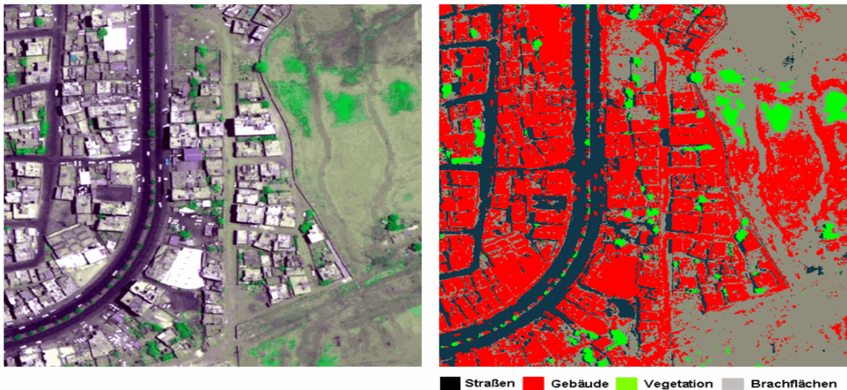
Abb. 7.1.5.2-2: Vergleich der Klasse Straßen bei der pixelbezogenen Klassifikation auf Bildebene (Bild rechts) und auf dem Originalsatellitenbild (Bild links).
