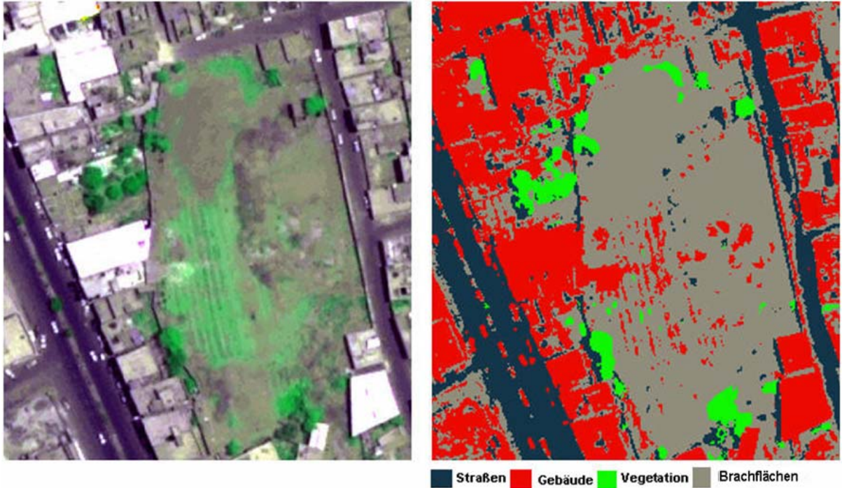
Abb. 7.1.5.1-2: Vergleich der Klasse Vegetation auf dem Satellitenbild (Bild links) und bei der pixelbezogenen Klassifikation auf Bildebene (Bild rechts).
