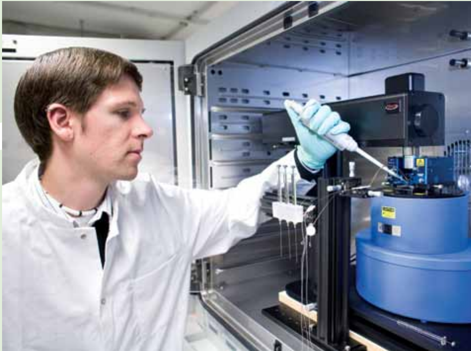
Am Rasterkraftmikroskop: Im Taschentuchlabor-Projekt trägt Michael Breitenstein Biomoleküle auf eine funktionale Oberfläche auf.
