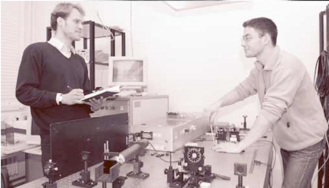
Beim Einrichten: Mit fasergekoppelten Detektoren können Professor Martin Ostermeyer (li.) und Sebastian Bange einzelne Photonen eines verschränkten Zustandes nachweisen.
