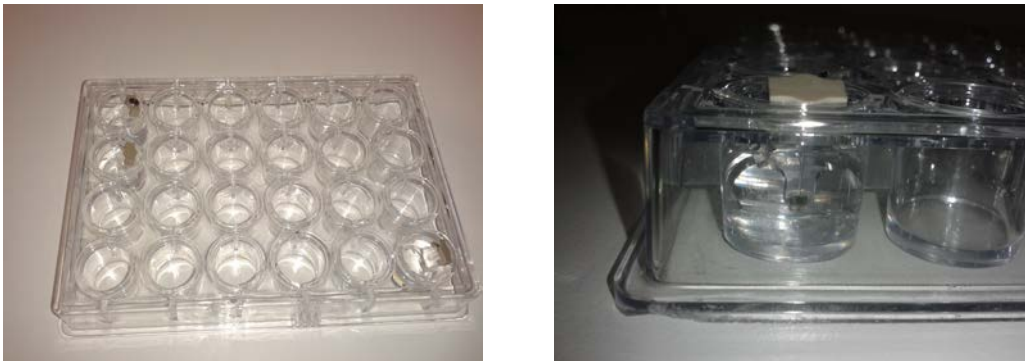
Abbildung 3.3: (links) Verwendung einer 24-Loch-Mikrotiterplatte für die Langzeitlagerung der verwendeten Pipetten. Die Kavitäten sind mit bidest. Wasser gefüllt. (rechts) Darstellung der Seitenansicht einer Kavität mit einer in bidest. Wasser gelagerten Pipette. Die Pipettenöffnung befindet sich im Wasser und das Reservoir ist mit einer Verbindungseinheit verschlossen.
