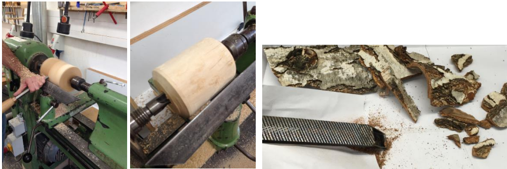
Abbildung 121: Zerkleinerung des Innenholzes und der Rinde
