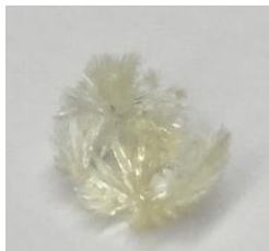
Abbildung 132: 4-(4-Hydroxyphenyl)-butan-3-on-Kristalle, vor (A) und nach (B) Umkristallisation (Kap. 5.6.7.2)
