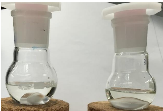
Abbildung 123: EMImTsO nach 3 Stunden bei 120 °C (links) und 160 °C (rechts).
