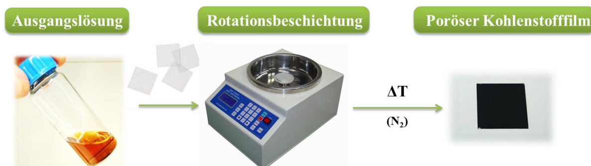
Abbildung 36 Schematische Darstellung der Präparationsprozedur von porösen Kohlenstofffilmen aus Tanninsäure und Harnstoff.
