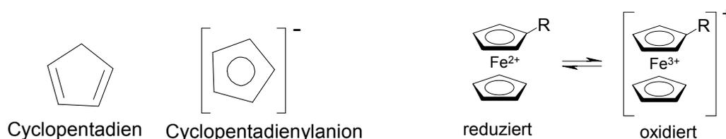
**Abb. 16** Strukturformeln von Cyclopentadien und Cyclopentadienylanion und Redoxverhalten von Ferrocen(-derivaten)
