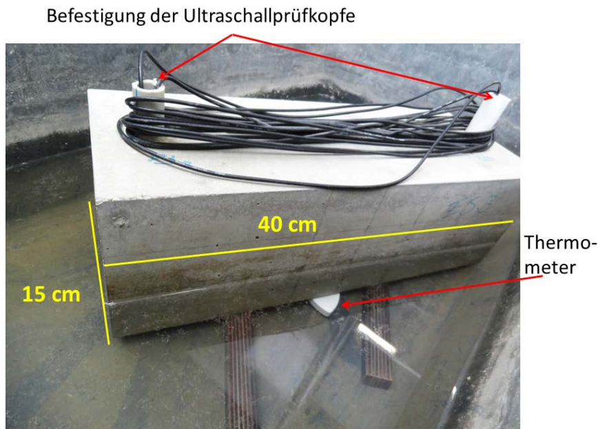
Abbildung 5.19: Betonprobekörper im Wasserbad zur Untersuchung des Feuchteinflusses auf das Ultraschallsignal eingebetteter Prüfköpfe.
