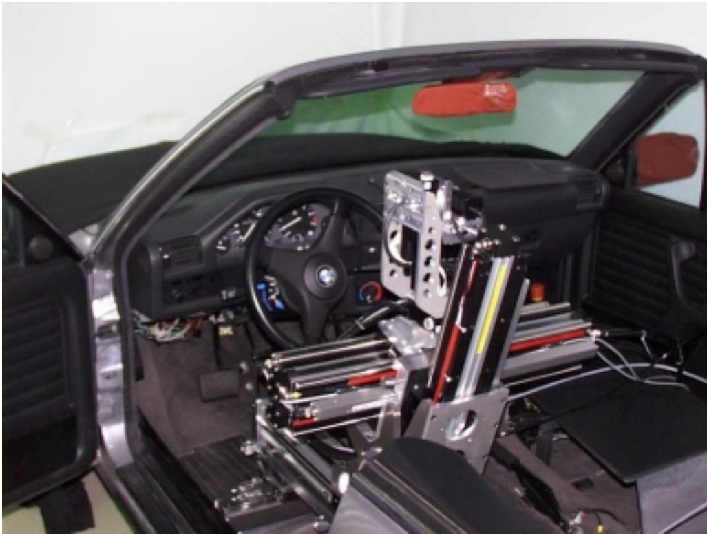
Abb. 6: Messroboter im Fahrzeug montiert.
