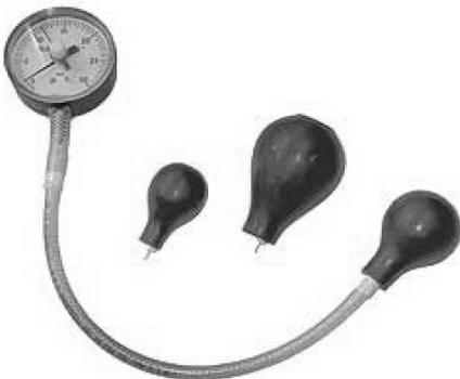
**Abb. 2.4** Vigorimeter mit auswechselbaren Gummiballons
