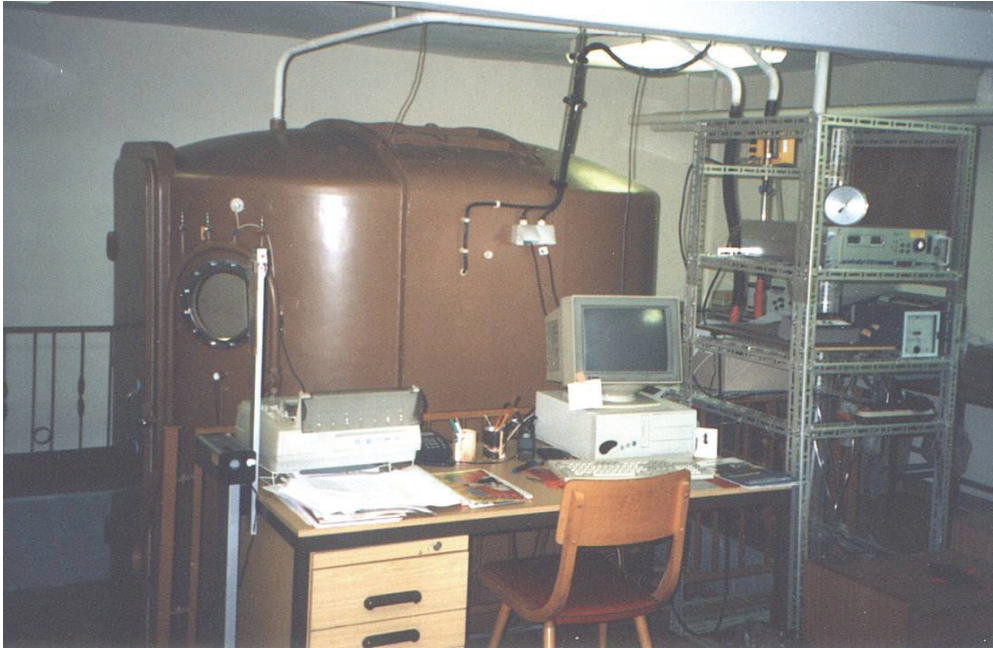
Abb. 4.6: Respirationsmessanlage für die indirekte Kalorimetrie
